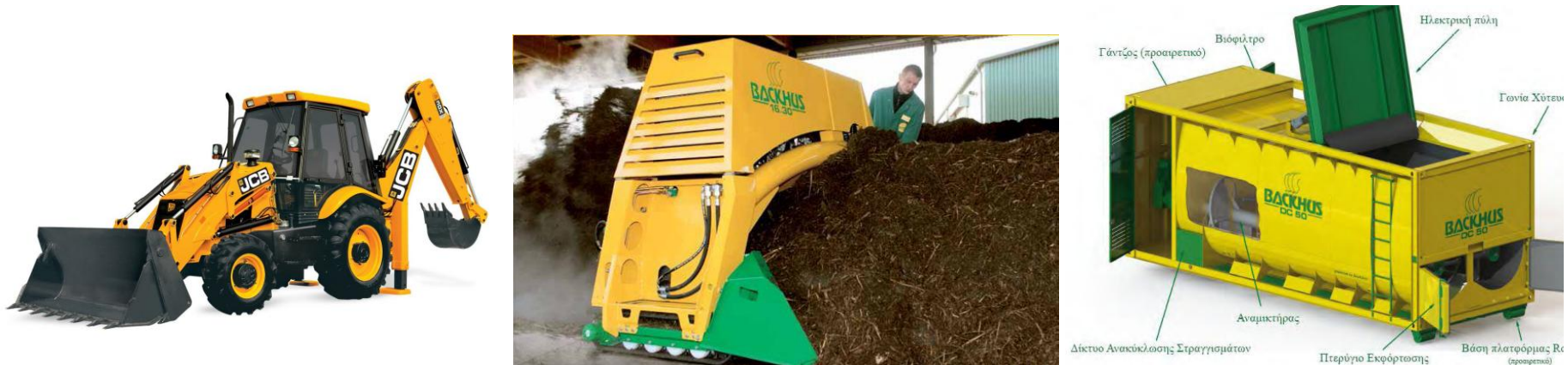
Εικόνα 20. Φορτωτής, Αναστροφέας, Μηχανικός Κομποστοποιητής
