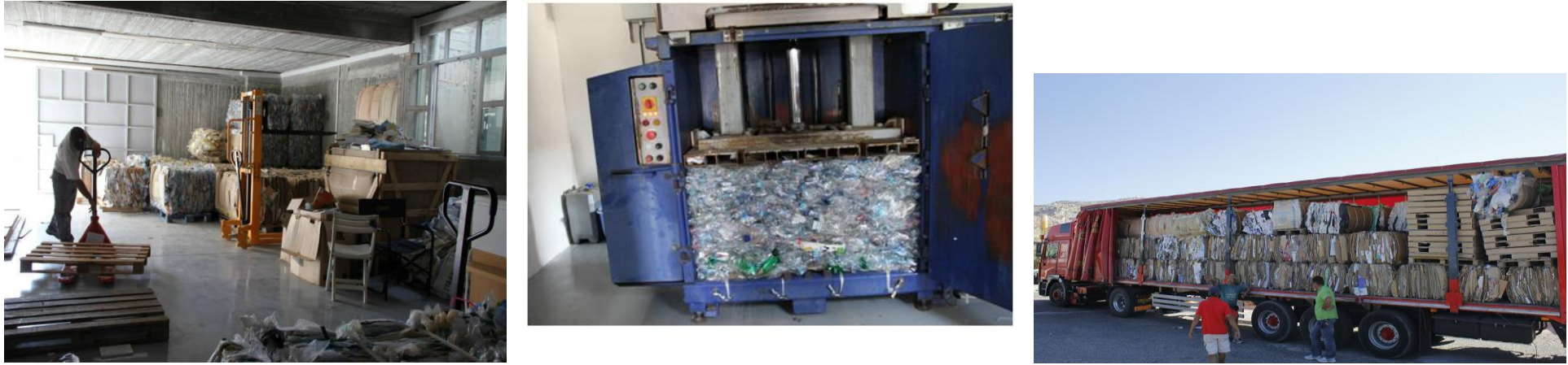
Εικόνα 19. Μονάδα Διαλογής Υλικών Ανακύκλωσης
